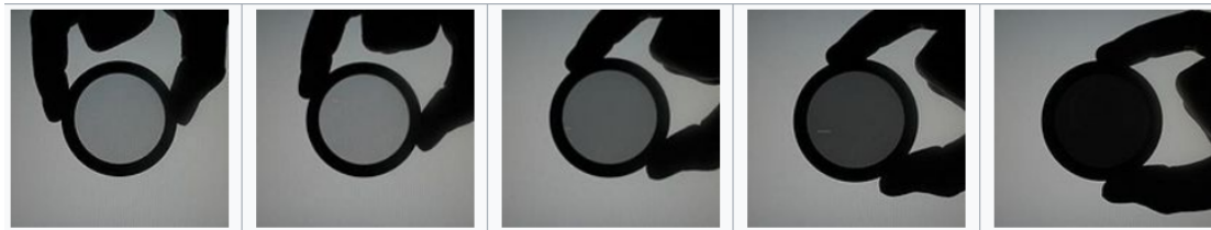
Figure 5 : Observation de l'effet d'un polariseur par absorption sur une lumière polarisée provenant d'un écran plat d'ordinateur. (source : Wikipedia, page sur la polarisation)
