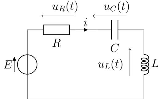
1 - À  $t = 0^-$  on a  $i(0^-) = 0$  (car l'interrupteur est ouvert),  $u_c(0^-) = 0$  (car le condensateur est déchargé).
