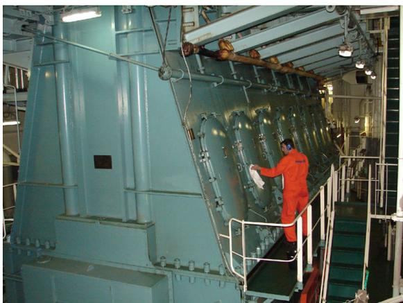
Moteur Diesel de puissance de 25 MW propulsant un pétrolier de 290 000 tonnes. Chacune des portes donne sur un des sept cylindres du moteur. Les pistons ont une course de plusieurs mètres, avec une vitesse assez lente. Ceci permet d'être assez proche du rendement maximal réversible, et d'atteindre  $\eta$  de l'ordre de 50%.
